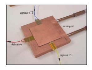
薄型ヒーターの両面に熱流東センサーを貼り付け、その外側を2枚の水冷板で覆います。ヒーターからの伝導熱は表裏同様に熱流東センサーを通過し、水冷板に吸収されます。
